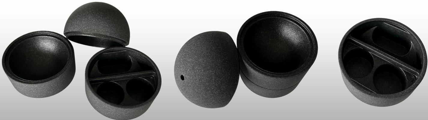
Der dreiteilige EPP-Formteilsatz wurde speziell für den sicheren Transport optischer Komponenten entwickelt. Er besteht aus einem Boden, einem Ring und einer Kuppel, die sich passgenau zusammenstecken lassen. Das verwendete expandierte Polypropylen (EPP) vereint optimale Dämpfungseigenschaften mit hoher Formstabilität und bietet gleichzeitig eine optisch ansprechende, matte Oberfläche durch gelaserte Strukturen.
