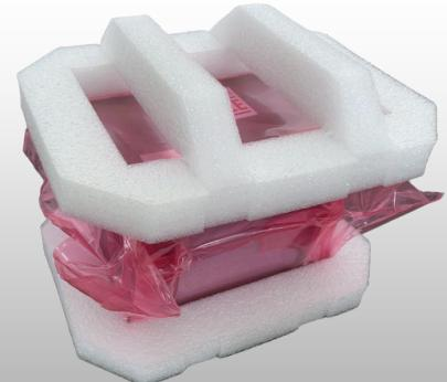
Die Reinraumverpackung wurde speziell für empfindliche Bauteile in der Halbleiterindustrie entwickelt und erfüllt strengste Anforderungen an Reinheit und Produktschutz. Die Lösung besteht aus einem Kunststoffbehälter mit präzise angepassten PE-Schaumeinlagen. Erforderliche Komponenten sind nach Reinraumklasse 6 gemäß DIN ISO 14644-1 gereinigt und zweifach in antistatische Dry-Shield-Beutel eingeschweißt.
